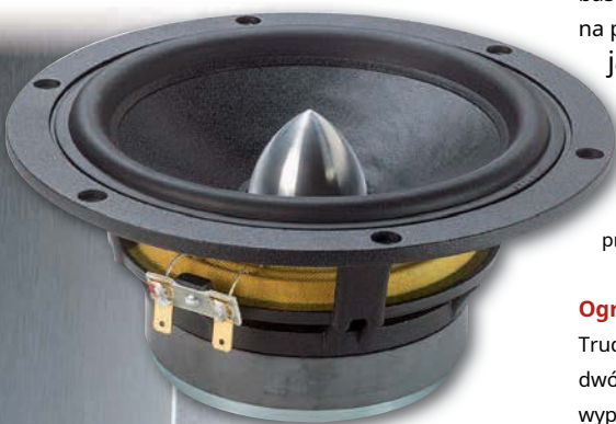
„Phase Plug” w środku głośnika niskotonowego zapobiega zakłóceniom i Wygaszanie powyżej błony
